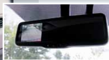
На версиях ix35 без навигации экран камеры заднего вида встроен в салонное зеркало.
